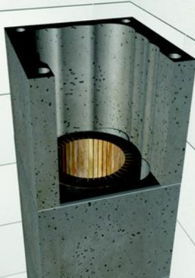
Наносим раствор м 150 на смонтированный блок ,монтируем предварительно подготовленный блок с отверстием для тройника подключения . Проверяем уровнем
