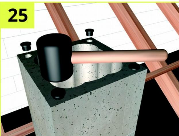
Перед кровлей (минимум 1 м ) в блок монтируем заглушки для арматуры , дальше монтируются детали дымохода после монтажа последнего блока дымохода в отверстия опускается арматура ф8 /ф10 мм и заливается раствором м 150.
