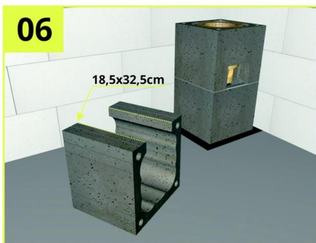
В блоке согласно канавок выпиливаем отверстие для тройника ревизии (18,5см). Для отверстия можно использовать готовый шаблон ( входит в расширенный пакет "MAX"). Проверяем уровнем
