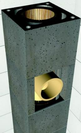
Наносим раствор м 150 на уже смонтированный блок ,монтируем следующий блок ,удираем излишки раствора , Монтируем каменную ватустыки каменной ваты должны быть на середине стенки блока, лишнюю каменную вату обрезаем. Проверяем уровнем
