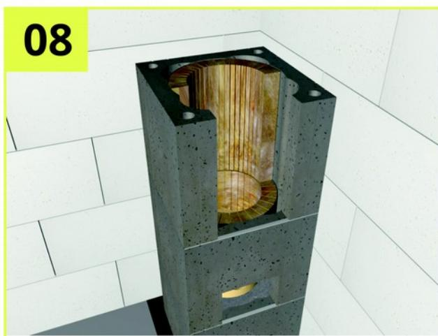
Монтируем каменную вату, оставляем отверстия для передней части тройника ревизии
