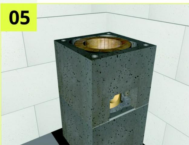
Монтируем каменную вату стыки каменной ваты должны быть на середине стенки блока ,лишнюю каменную вату обрезаем по верхнему краю блока
