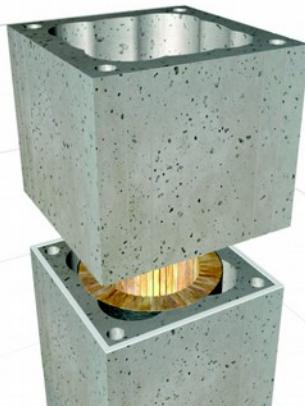
Наносим раствор м 150 на уже смонтированный блок ,монтируем следующий блок ,удираем излишки раствора , Монтируем каменную ватустыки каменной ваты должны быть на середине стенки блока, лишнюю каменную вату обрезаем. Проверяем уровнем
